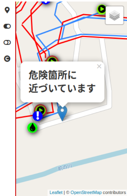
図 6.9: 注意画面。バイブレーションによって危険箇所に近付いていることを指摘 (日向地区水路ナビ 2018)
